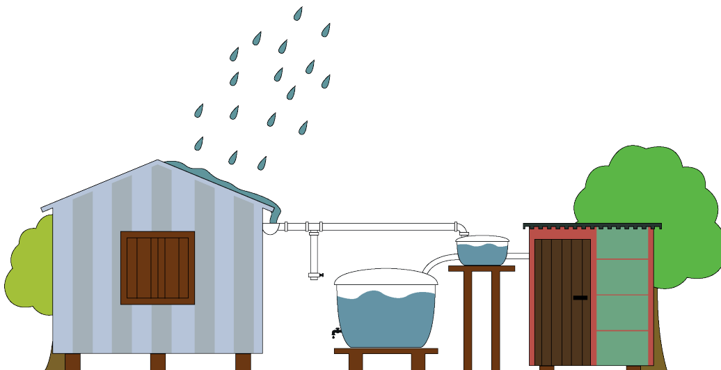
Figura 3. Esquema da captação de água da chuva no telhado da moradia em um sistema pluvial multiuso autônomo.
