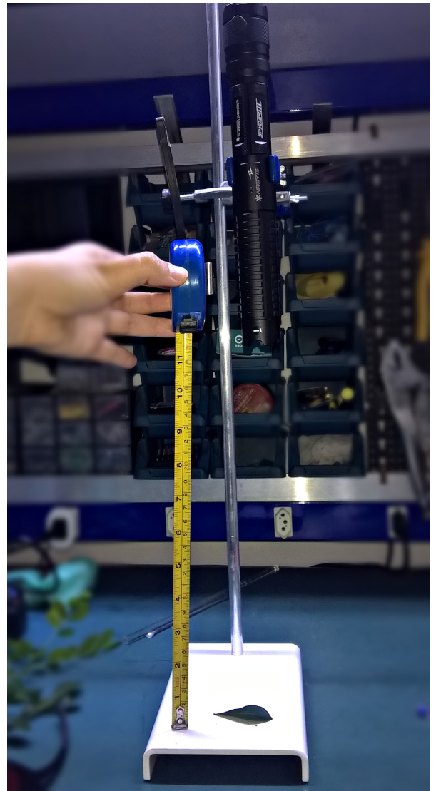
FIGURA 1: Suporte usado para exposição direta a radiação LASER das folhas e dos insetos.
