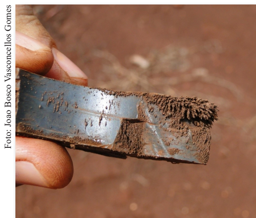
Figura 7. Atração magnética por imã de mão do material de solo com caráter férrico desenvolvido a partir de rocha eruptiva básica.
