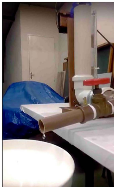
Figura 9: Registro fotográfico da saída de uma gota de água do protótipo durante execução de ensaio.
