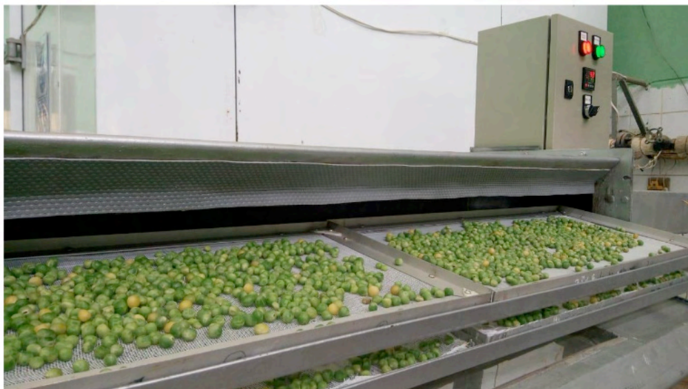
FIGURA 6. Muestras de frijol de palo ( Cajanus cajan L) en pleno proceso de secado, utilizando un secador de bandejas tipo túnel.
