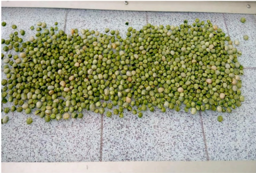
FIGURA 7. Muestras de frijol de palo luego del proceso de secado a 55 °C; 9,0 horas y 5,0 m/ seg de velocidad de aire.
