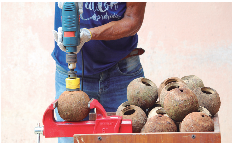
Figura 2. Abertura de fruto da castanha-da-amazônia ( Bertholletia excelsa Bonpl.) com serra-copo acoplada a uma furadeira elétrica.
