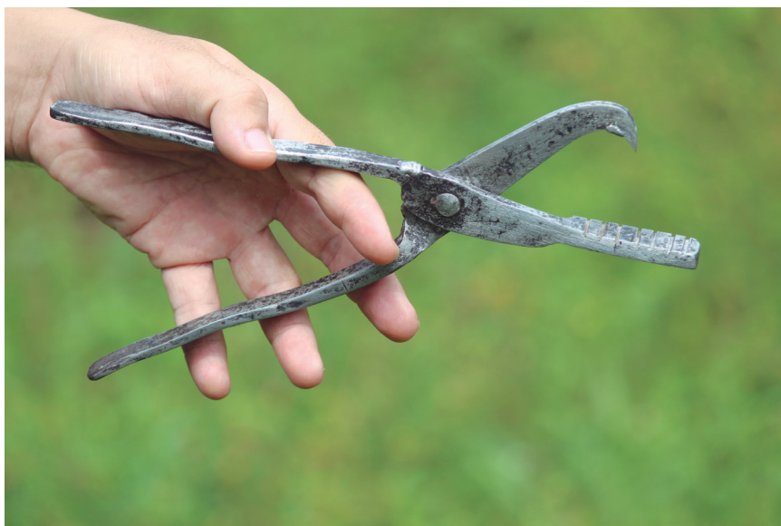
Figura 4. Alicates desenvolvidos na Embrapa Amazônia Oriental para o descascamento de sementes de castanheira-da-amazônia ( Bertholletia excelsa Bonpl.).
