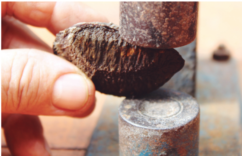
Figura 5. Posição da semente de castanha-da-amazônia ( Bertholletia excelsa Bonpl.) entre as faces da prensa para se efetuar com eficiência a fratura ou a remoção de uma pequena porção da casca.
