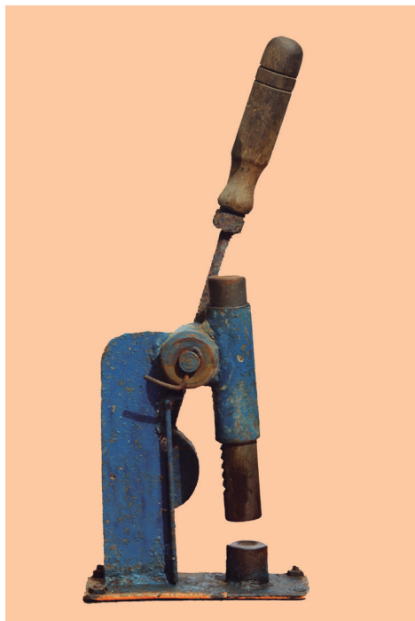
Figura 3. Prensa utilizada no processo de descascamento de sementes de castanha-da-amazônia ( Bertholletia excelsa Bonpl.).
