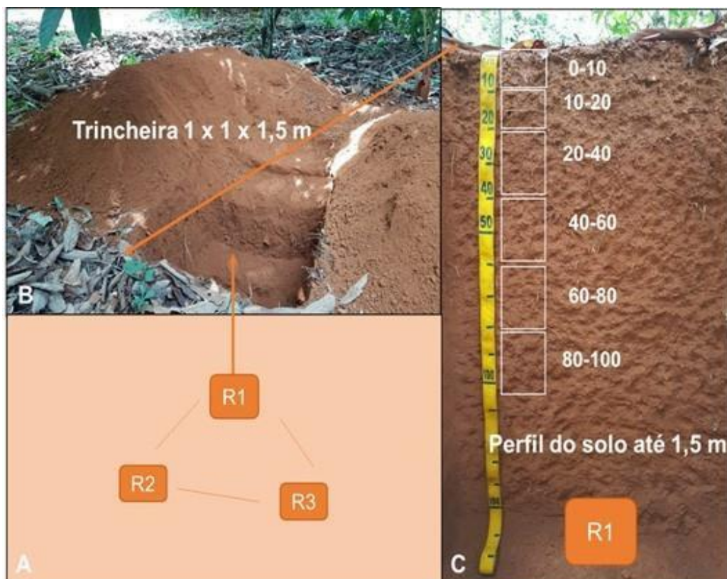
Figura 3. Esquema da coleta das amostras do solo por área amostrada no Ramal Baixa Verde, Nova Califórnia, Porto Velho, RO. A = Pontos de coleta escolhidos ao acaso; B = Trincheira aberta; C = Descrição do perfil do solo e camadas amostrais.
