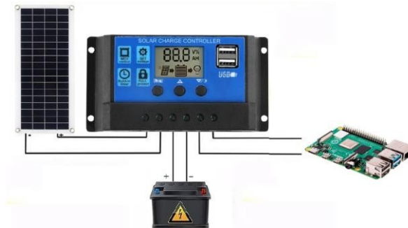
Figura 7 - Placa solar, controlador de carga, bateria, raspberry pi. Fonte: os autores
