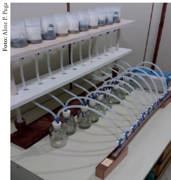
Figura 6. Sistema de extração a vácuo e filtragem usado para avaliação da liberação de nitrogênio a partir de fertilizantes nitrogenados.
