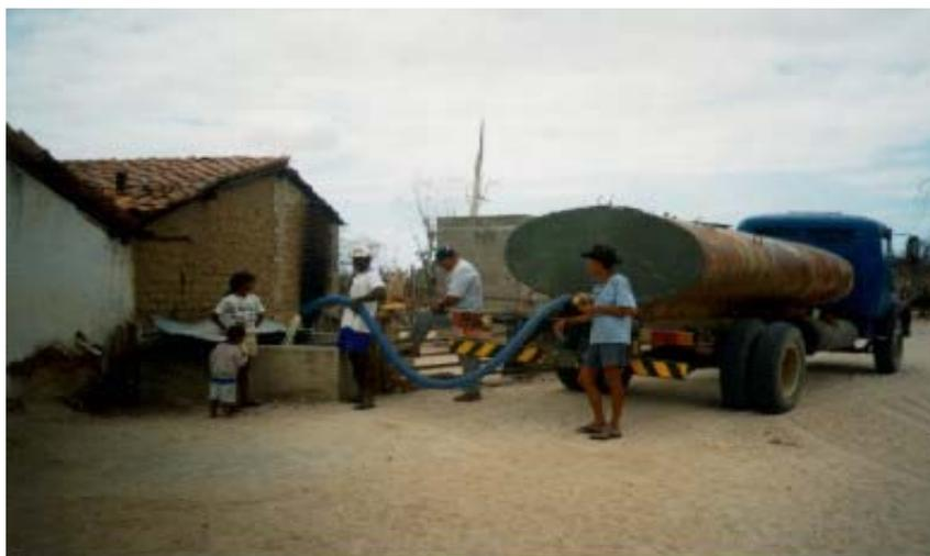
**Figura 4.** Carro-pipa abastecendo cisterna de pequenos agricultores.
