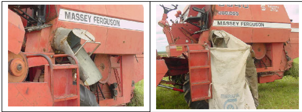
Figura 1 - Detalhes do tubo adaptado para a descarga de sementes de capim bufel
