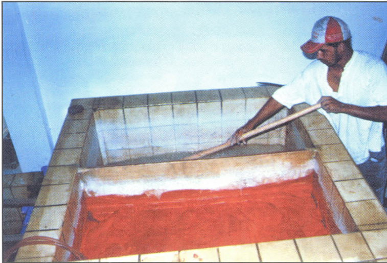
Fig. 20. Tanques para dissolução de fertilizantes usados como acessórios dos equipamentos de irrigação de fertilizantes.
