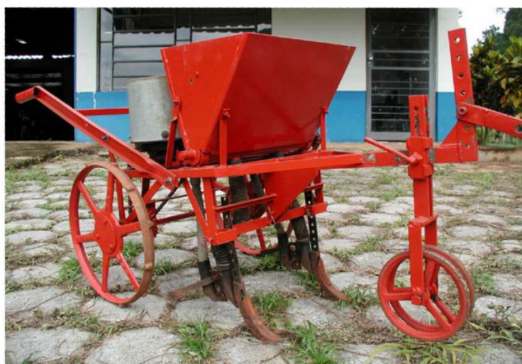
Figura 1. Vista parcial da semeadora adubadora, montada com duas linhas para semeadura convencional
