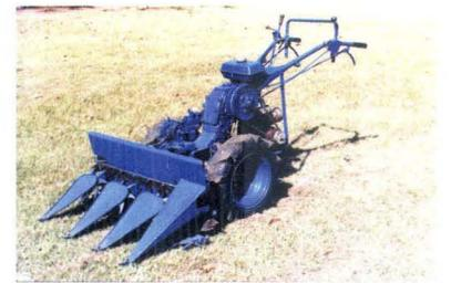
São máquinas destinadas às pequenas lavouras de arroz, constituídas, basicamente, dos seguintes mecanismos: chassi com rabiça montado sobre duas rodas; barra de corte com movimentos alternativos; molinete para apoiar as plantas para a ação da barra de corte e motor à gasolina com potência de cerca de 3,5 cv. Algumas ceifadoras possuem um depósito de plantas atrás da barra de corte, que são descarregadas no campo
