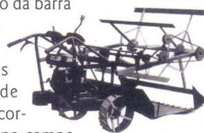
de forma intermitente, enquanto noutras, como a desenvolvida na Embrapa Arroz e Feijão, possuem três molinetes em forma de estrela, que conduzem as plantas para um transportador de correia descarregá-las no campo, de forma contínua, formando uma leira. Num ensaio de campo esta ceifadora apresentou capacidade operacional de 0,29 ha/h e perda de arroz de apenas 1,4% da produção.
