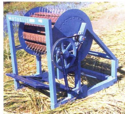
ros pelo operador e aplicados sobre o cilindro degranador em movimento) ou de forma contínua (quando os feixes são lançados na máquina, entre o cilindro e o côncavo, para serem trilhados e separados os grãos da palha).
