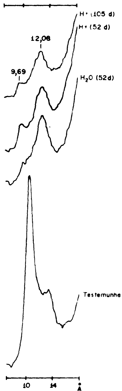
Figura 8. DIFRATOGRAMAS DE RAIOS-X DA FRAÇÃO 0,5 \mu -2,0 \mu DO HORIZONTE B 22 SATURADA COM POTÁSSIO, AQUECIDA A 300°C; ANTES E APÓS OS TRATAMENTOS.
