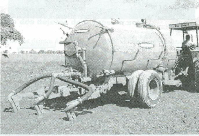
**Figura 3.** Distribuição localizada, através de injeção no solo, com uso de equipamento tratorizado.
