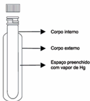
Figura 3.7. Representação esquemática do reator fotoquímico UV LABEL 10.
