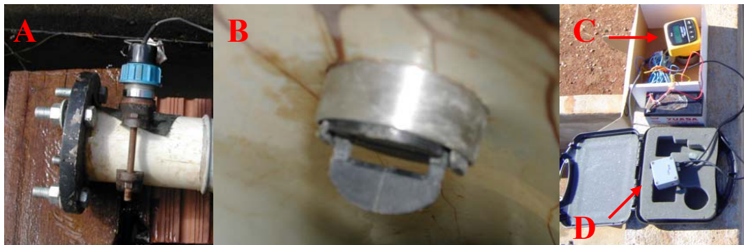
Figura 2. Sensor eletrônico de vazão, montado em tubo de PVC de esgoto de 100 mm (A), detalhe da turbina tangencial (B) e visor do sensor de vazão (C), e registrador de dados de dois canais, LogBox (D).
