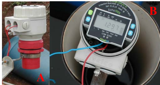
Figura 4. Sensor de nível ultrassônico (A), com detalhe do visor e do poço tranquilizador (B).
