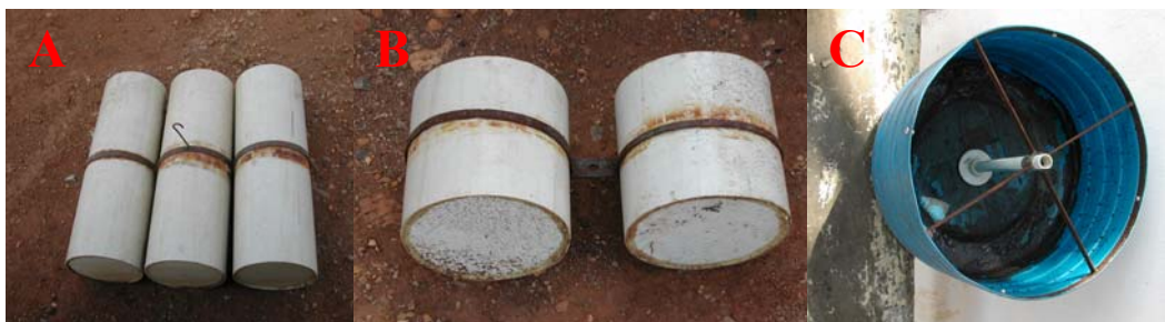
Figura 5. Flutuador 1 de três tubos (A), Flutuador 2 de dois tubos (B) e Flutuador 3 de segmento de “bombona” (C).
