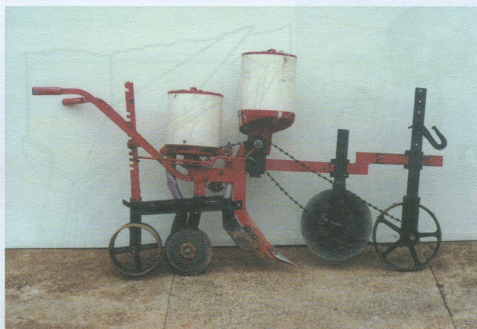
Figura 15 - Semeadora-adubadora de plantio direto de tração animal de uma linha - Mafrensi
