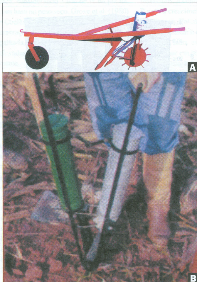
Figura 2 - Semeadoras-adubadoras FONTE: (Figura 2A) Werner (1999) e (Figura 2B) Manchete Rural (1997). NOTA: Figura 2A - Semeadora-adubadora de tração animal; Figura 2B - Semeadora-adubadora manual.
