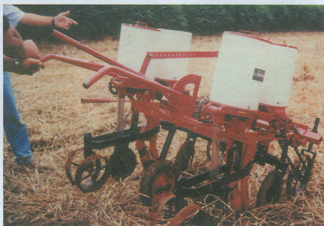
Figura 16 - Semeadora-adubadora de plantio direto de tração animal de duas linhas - Mafrensi
