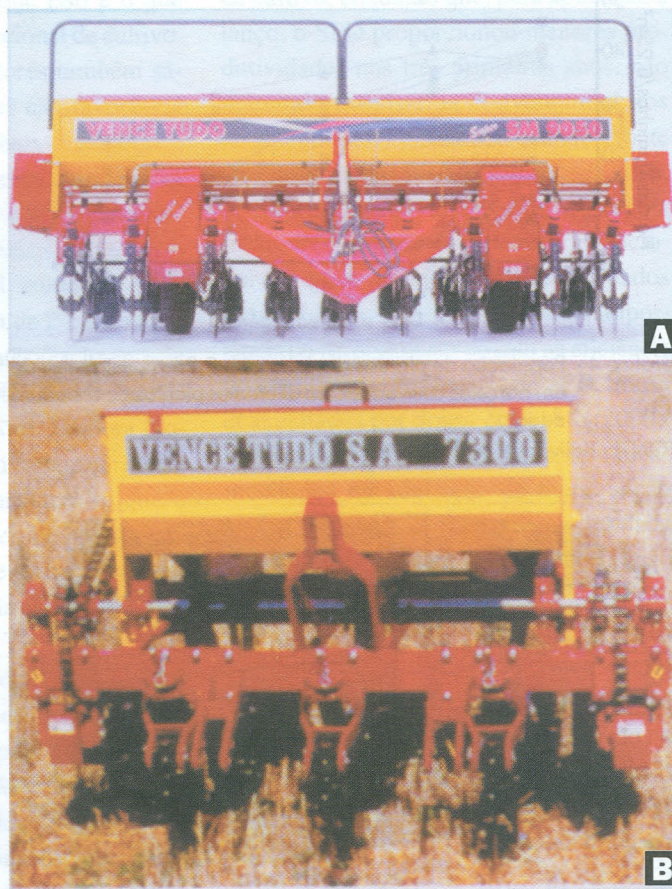
Figura 3 - Semeadoras tratorizadas FONTE: (Figura 3B) Vence Tudo (1999). NOTA: Figura 3A - Semeadora atrelada (de arraste); Figura 3B - Semeadora acoplada (hidráulica).
