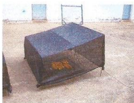
Figura 3: Aparelhagem montada com sombrite para secagem das espigas de milho. As espigas ficaram dispostas sobre peneiras a 5 cm do solo sobre o sombrite.
