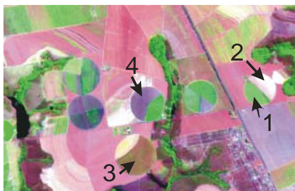
Figura 2. Parte de uma imagem Landsat/ETM+ do Distrito Federal obtida em 20 de julho de 2001 e que mostra uma concentração de seis pivôs-centrais (estruturas circulares) com pelo menos quatro classes espectrais diferentes (1 = cultura agrícola com biomassa verde relativamente densa; 2 = solo coberto com palhada seca; 3 = cultura agrícola num estágio inicial de desenvolvimento, isto é, com biomassa verde relativamente baixa; e 4 = solo predominantemente exposto e com elevada porcentagem de umidade).
