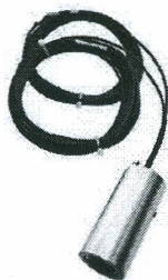
Figura 1. Transdutor digital de temperatura a infravermelho (TDTIV) (“Apogee Instruments”, IRTS-P5), com elemento sensor composto de dois pares de termopar, tipo K, utilizado para registrar remotamente as temperaturas da parte superior do dossel de culturas anuais (Tdc) e do corpo do sensor (Tcs).
