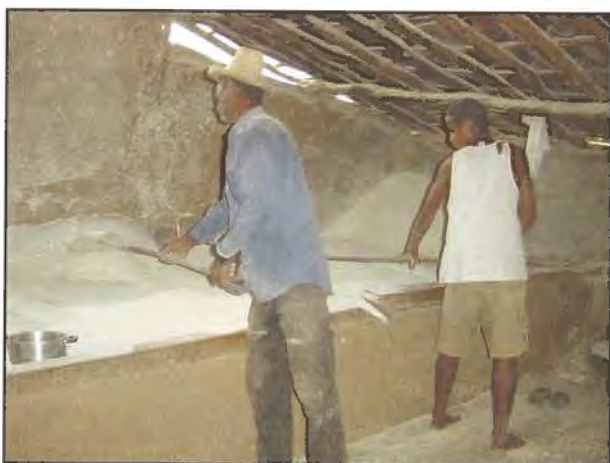
Fig. 24. Forno plano, com sistema de agitação manual. Santaluz, BA, 2003.
