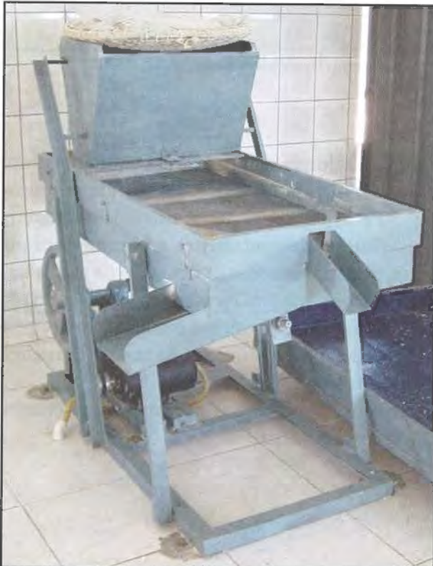
Fig. 28. Peneiragem automática para pequena escala. Vale do Rio Gavião, BA, 2002.
