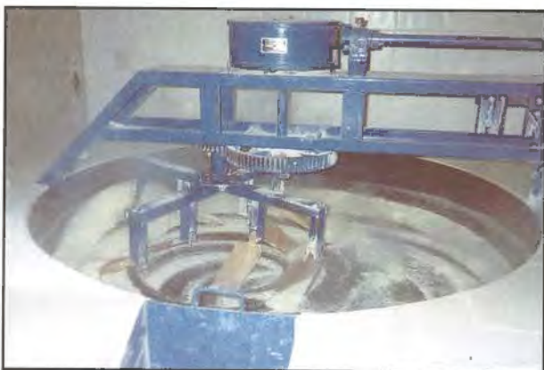
Fig. 25. Forno plano, com sistema de agitação planetário. Belo Campo, BA, 2002.
