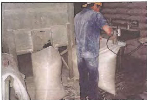
Fig. 32b. Ensacamento da farinha – costura (sacos de 50 kg). Conchal, SP 2001.
