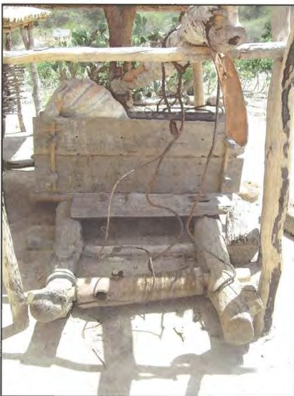
Fig. 17. Prensa rústica, com sistema de amarração. Brotas de Macaúbas, BA, 2003.
