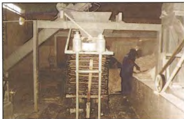
Fig. 20b. Prensa hidráulica – prensagem da massa. Conchal, SP, 2001.
