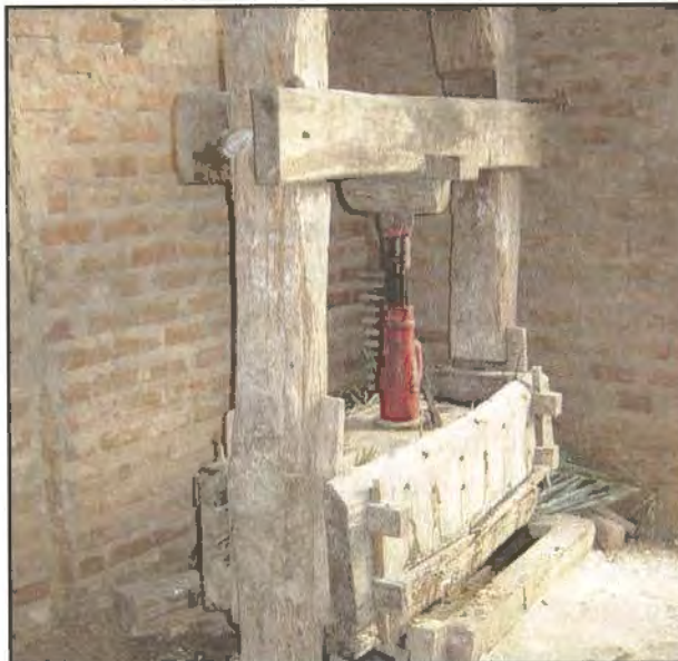
Fig. 19. Prensa rústica com sistema de macaco hidráulico. Santaluz, BA, 2003.
