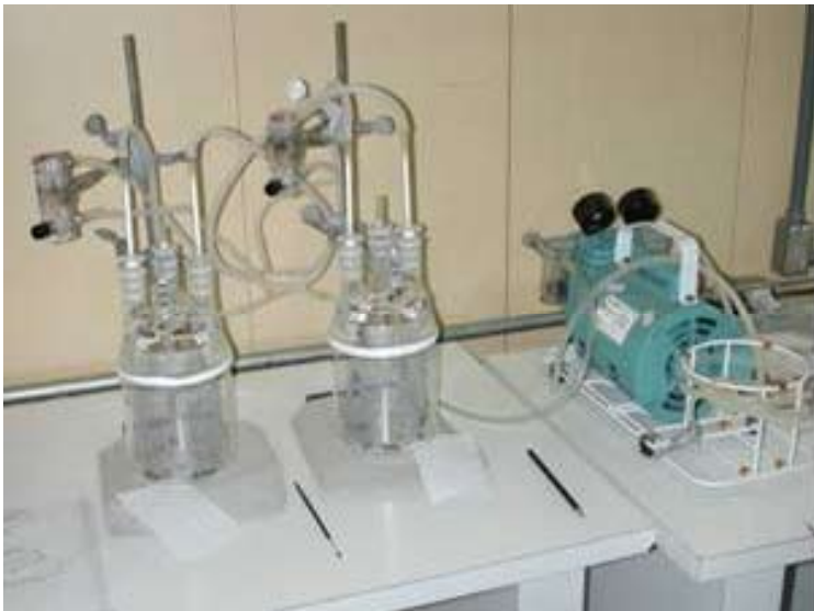
Fig. 4. Exemplo de um sistema de aeração para coleta de voláteis de insetos.
