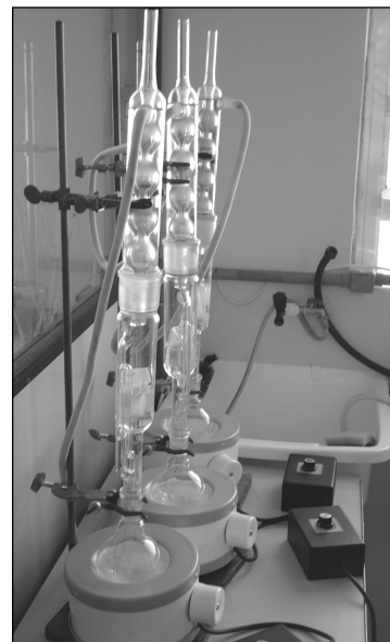
Figura 2. Sistema de extração Soxhlet montado no LAPPA (CEFET/RS)
