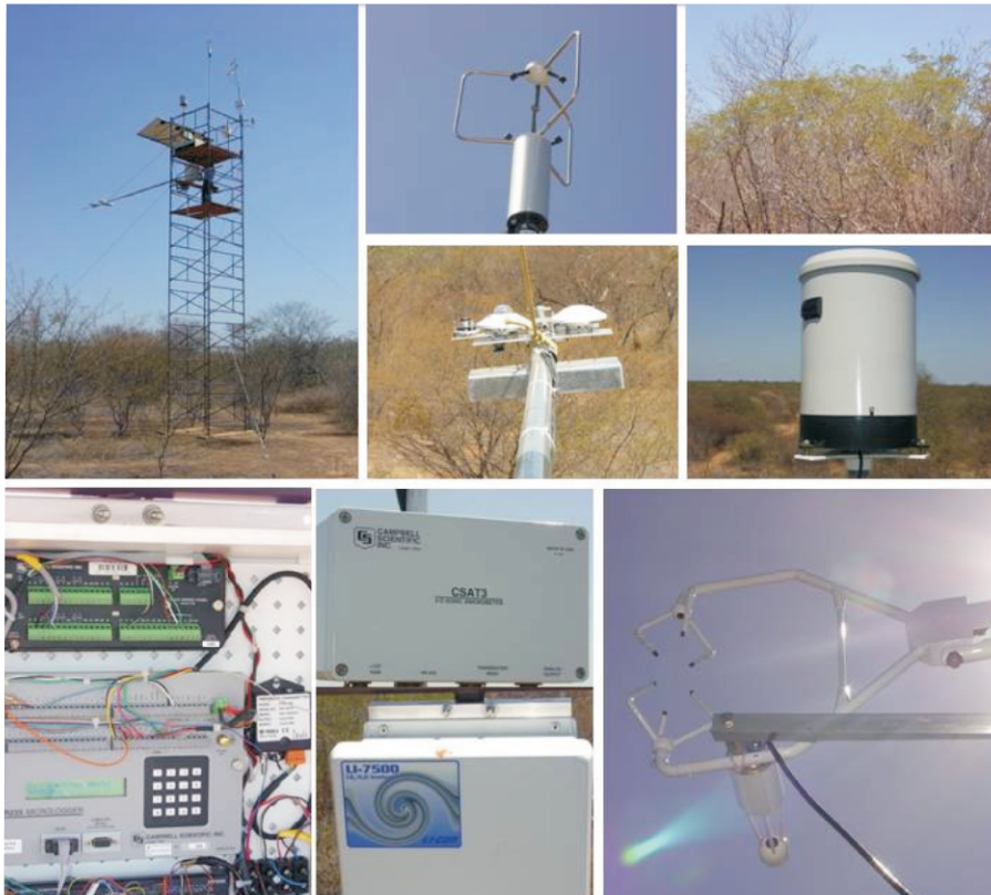
Figura 2. Torre micrometeorológica e sensores para medições de elementos do tempo e clima em área de caatinga no Semiárido brasileiro.
