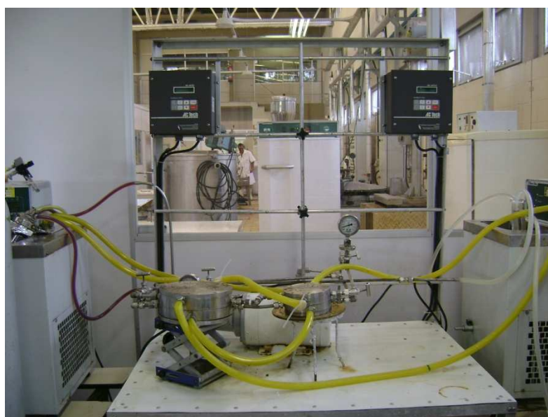
Figura 4 - Sistema laboratorial de evaporação osmótica
