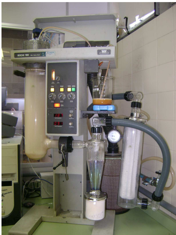
Figura 2 - Mini spray dryer Buchi Modelo B-190
