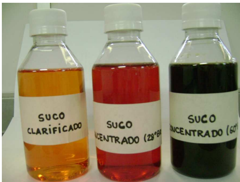
Figura 8 - Suco de acerola clarificado por MF, pré-concentrado por OI e concentrado por EO
