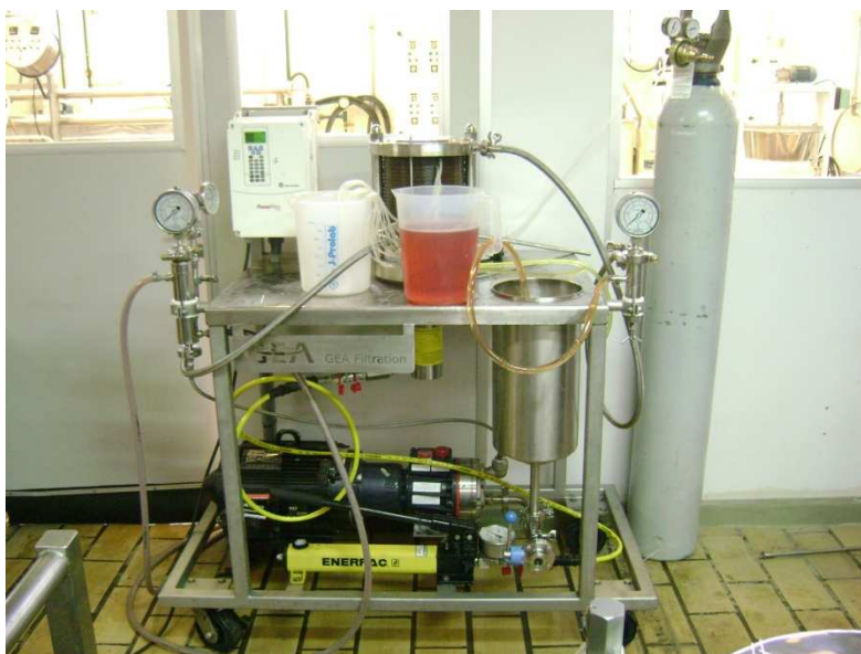
Figura 3 - Sistema semi-piloto de Osmose Inversa
