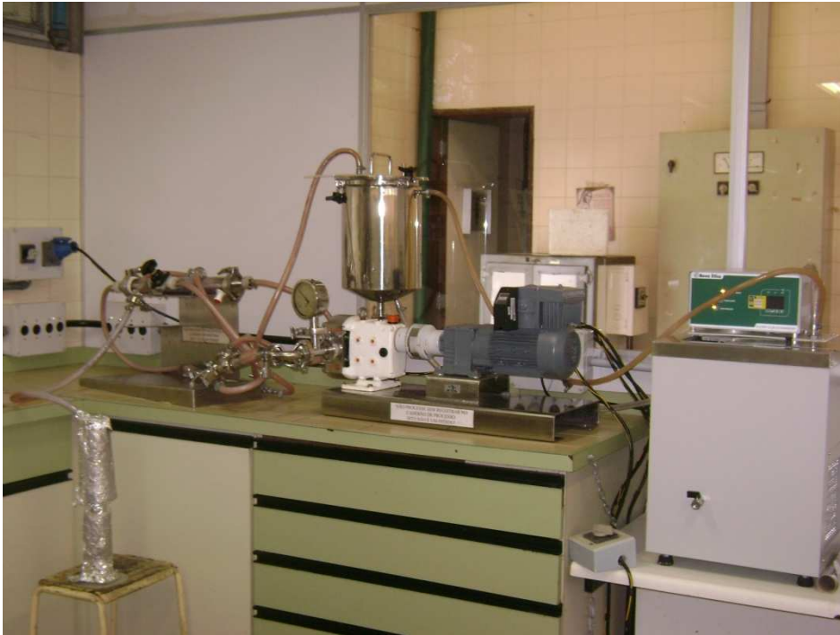
Figura 6: Sistema semi-piloto com membranas poliméricas de ultrafiltração/microfiltração PROTOSEP IV da Koch Membrane System , EUA
