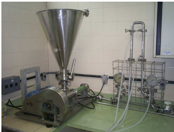
Figura 5. Sistema semi-piloto de microfiltração com membranas cerâmicas da TIA, Technique Industrielles Appliquées , França
