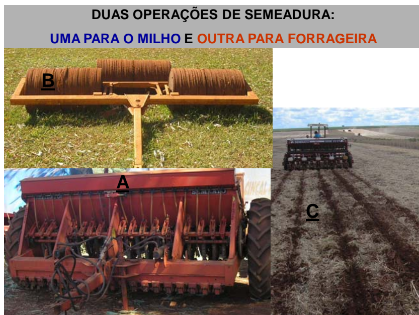
Fig. 1. Semeadoras utilizadas para implantação do consórcio de milho com braquiária. A: sementeira de forrageiras; B: rolo compactador e C: sementeira de milho.
