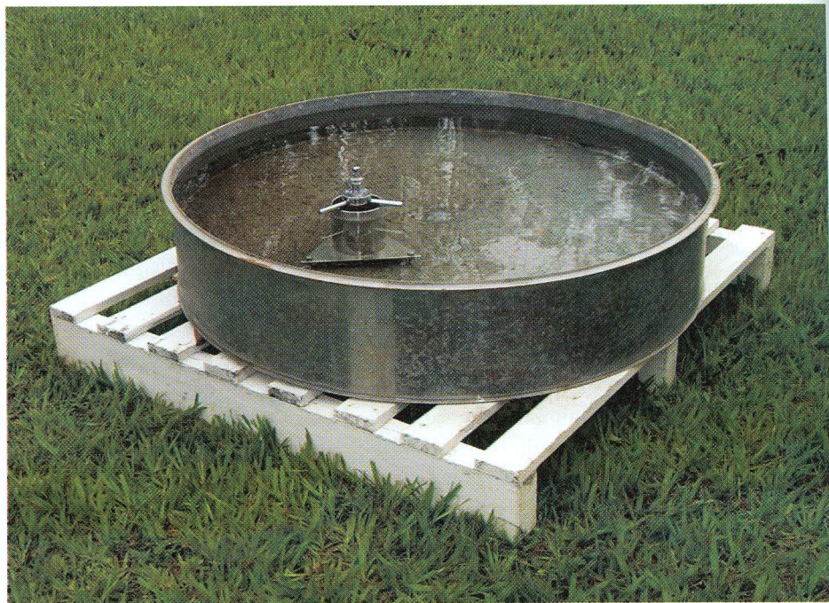
Figura 1 - Tanque de evaporação Classe A, utilizado para estimar a evapotranspiração de referência (ETo)
