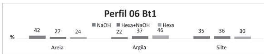
Figura 8. Proporções de Areia, Silte e Argila de Horizonte Bt1 (AC – P06) influenciadas por diferentes dispersantes químicos.
