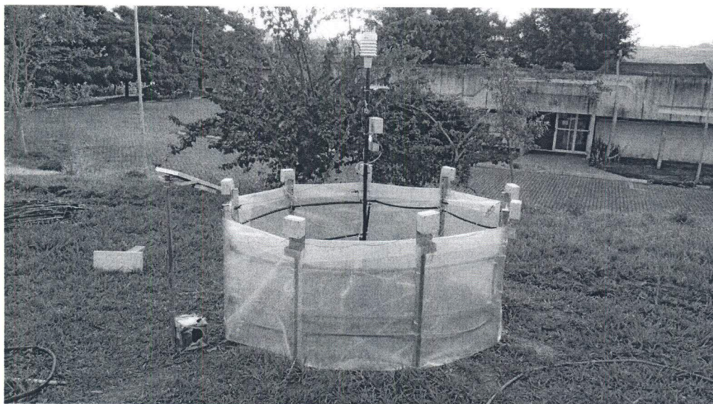
Figura 3 – O experimento OTC implantado com a rede de sensores sem fio no padrão ZibBee.
