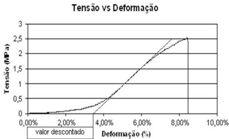
Figura 3 – Tratamento matemático para as amostras que apresentaram o fenômeno do sanfonamento.
