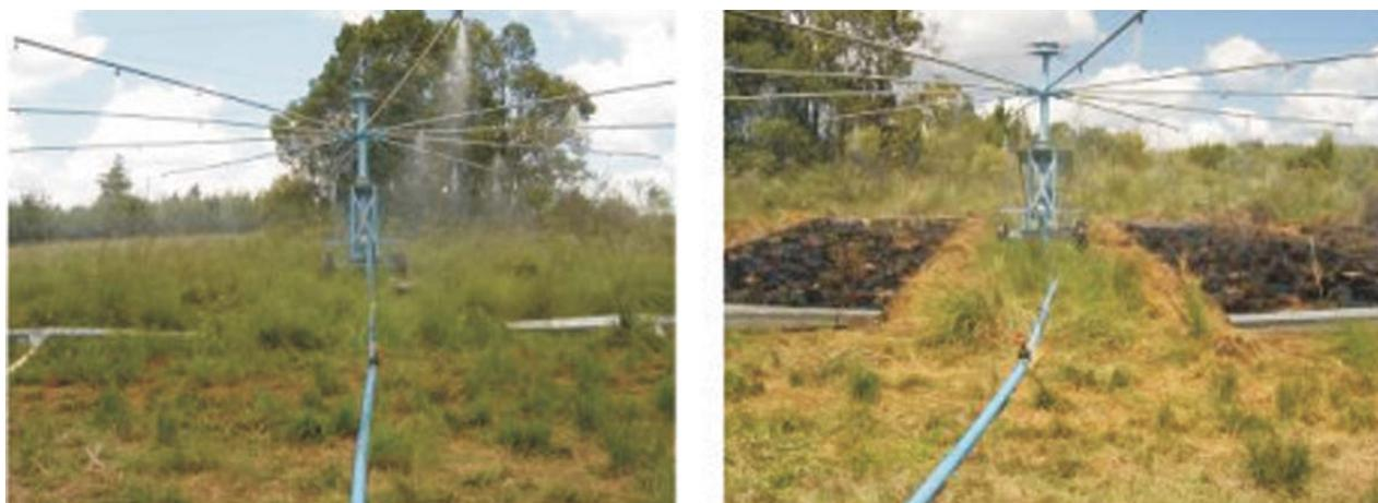
Figura 1. Simulador de chuva em operação sobre os tratamentos de campo nativo, sem queima da vegetação (esquerda) e com queima (direita), em um Latossolo Bruno aluminoférrico típico, em janeiro de 2008.
