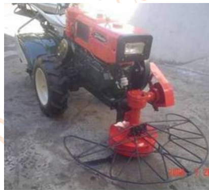
Figura 9- Mini-tractor Tobata com roçadeira frontal (pesquisa ainda não validada) para o corte mecânico de uma linha de plantas de gergelim. (Foto Diego Antonio Nóbrega Queiroga).
