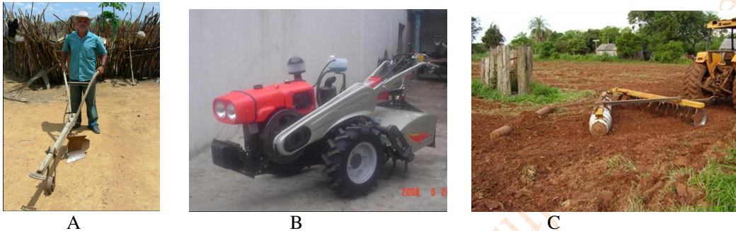
Figura 4. A) Cultivador de aiveca de tração animal para preparo do solo; B) Mini-tractor cultivador utilizado pelos produtores de São João do Sabugi, RN para preparo do solo e capinas dos campos de gergelim; e C) Operações executadas simultaneamente pelo trator (redução de custos): gradagem e nivelamento do solo com o arrasto de barra niveladora (toco roliço amarrado à grade). (Foto A: Vicente de Paula Queiroga; Fotos B e C: Odilon Reny Ribeiro da Silva).
