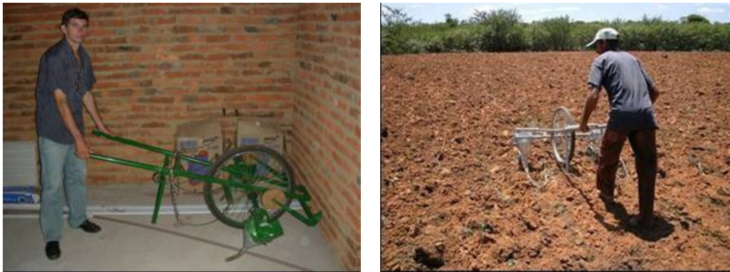
Figura 5. Semeadora mecânica manual de duas linhas para semeadura de sementes de gergelim. Detalhe da semeadora (Esquerda) e prática de semeadura (Direita), utilizada nos municípios de Bela Vista e de São Francisco de Assis do Piauí, PI, 2010. (Fotos: Vicente de Paula Queiroga).
