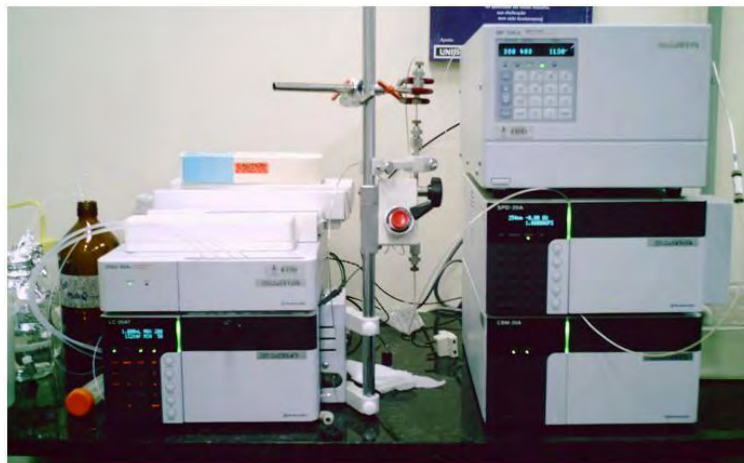
Figura 6. Foto do cromatógrafo líquido de alta performance, situado no Laboratório de Proteínas Tóxicas, da professora Célia Carlini/UFRGS, equipado com coluna Shin-pack CLC-ODS (M), Shimadzu, (150mm x 4,6mm, tamanho da partícula de 5 \mu m e diâmetro de poro 100 \text{\AA} ) e coluna guarda Shin-pack, Shimadzu, CLCG-ODS. Programado para um gradiente de eluição de 5% a 90% Metanol, pH 3,9.
