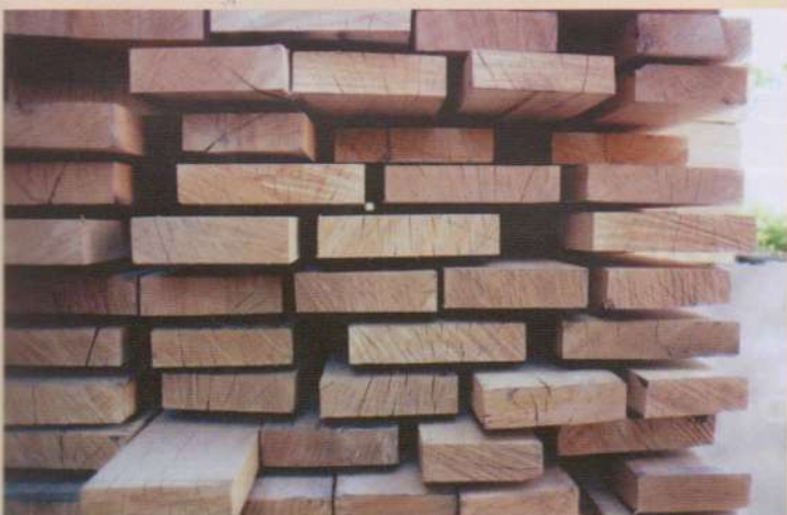
Exemplo de secagem inadequada, resultando em rachaduras de topo e de superfície em madeira de Tauari.
