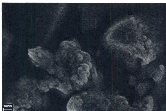
Figura 3. MEV da amostra sintetizada a partir de Cloreto de Ferro (III) hexahidratado e Ferro Metálico (70/30)% em 24 horas a 250°C.
