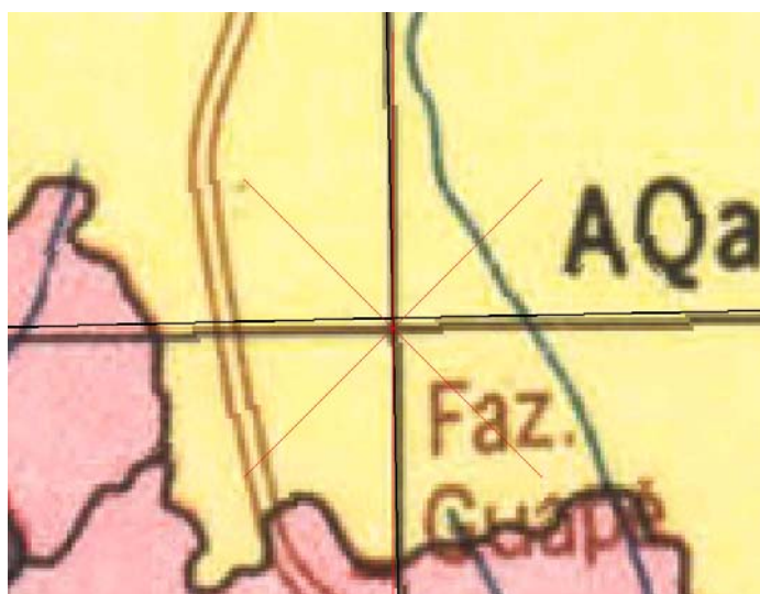
Figura 3: Detalhe do deslocamento do ponto de referência e do ponto lido na carta digitalizada.
