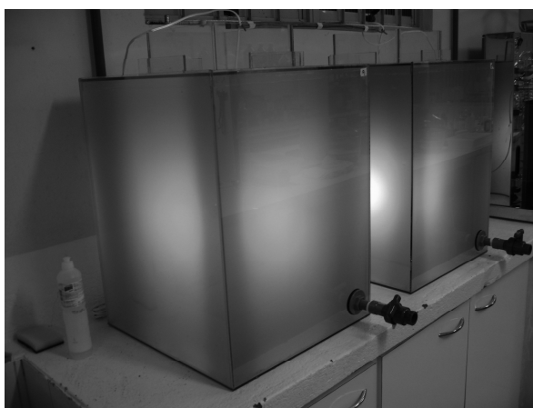
Figura 1 – Reatores contendo o efluente de indústria de abate e processamento de tilápias inoculado com R. gelatinosus .
