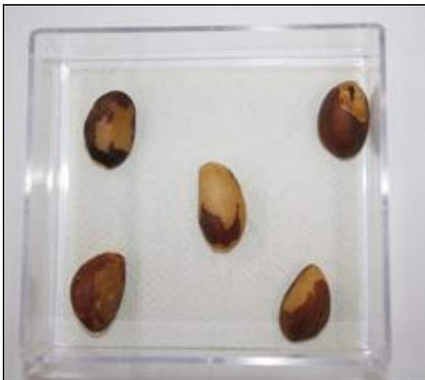
Figura 7 Câmara úmida montada com cinco castanhas.
