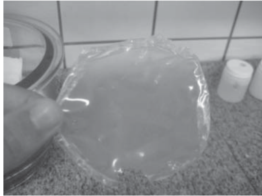
FIGURA 6 – FOTO DE FILME BIODEGRADÁVEL À BASE DE FÉCULA DE RIZOMAS FILHO DE MANGARITO, ÁGUA E GLICEROL
