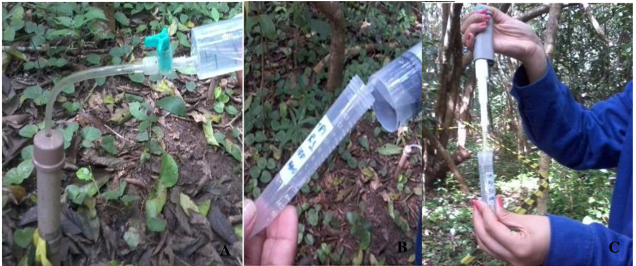
Figura 4. Procedimento de amostragem da solução do solo. A) Coleta da solução; B) Amostra sendo fracionada; C) Adição de HNO 3 para preservação da amostra. Estação Experimental do Caldeirão (Embrapa/CPAA), Iranduba – AM.
