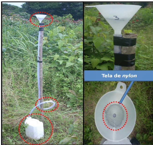
Figura 2. Coletor de água da chuva com destaque para cada um dos componentes de sua constituição
