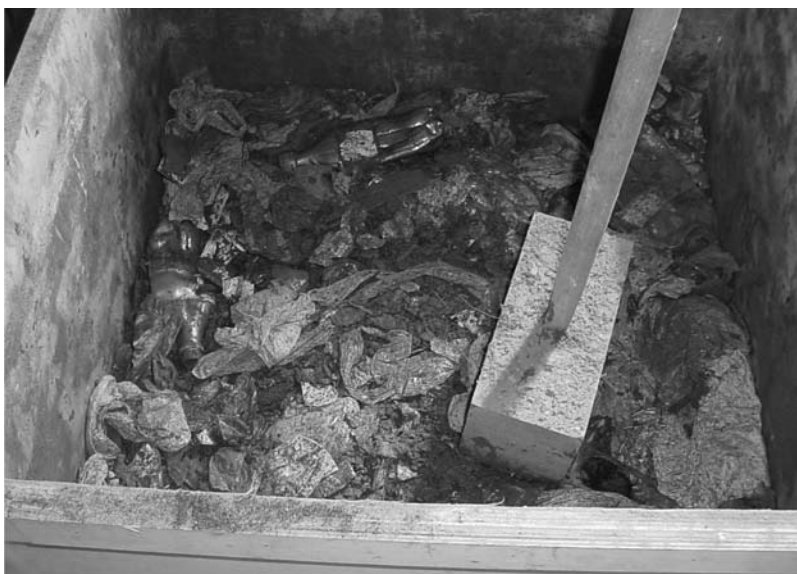
Fig. 5 – Compactação dos RSU em camadas.
