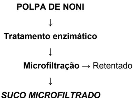
Figura 10: Fluxograma de microfiltração da polpa de noni.
