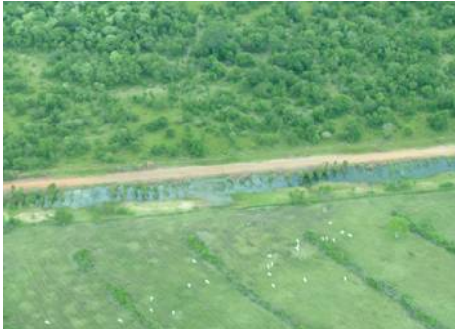
Figura 4. Caixa de empréstimo ao longo de rodovia vicinal no Pantanal, município de Aquidauana, registrada em 2007. A parte superior da foto apresenta a vegetação original (cerrado), e a parte inferior pastagem cultivada. Notar as "leiras" criadas durante o processo de desmatamento.
