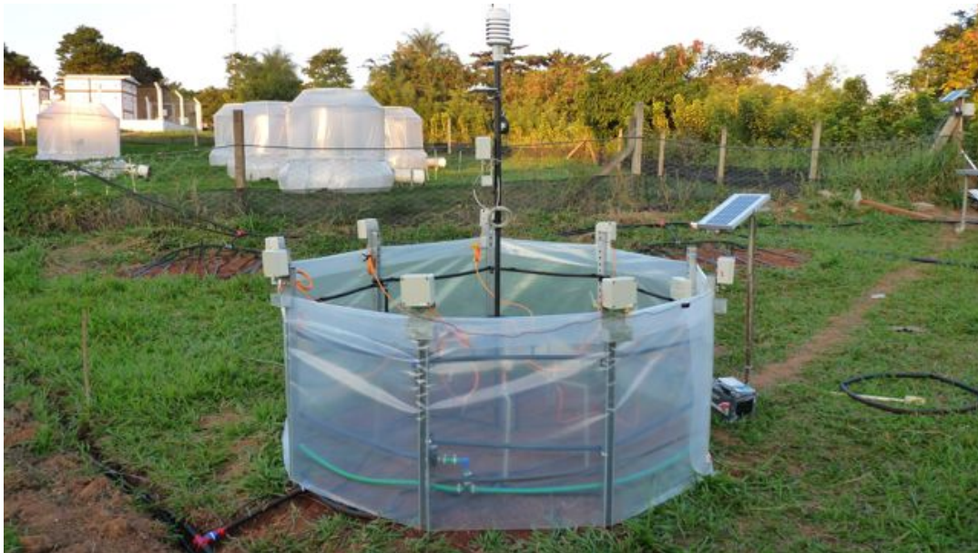
Figura 2 – O experimento OTC implantado com a rede de sensores sem fio no padrão ZibBee .
