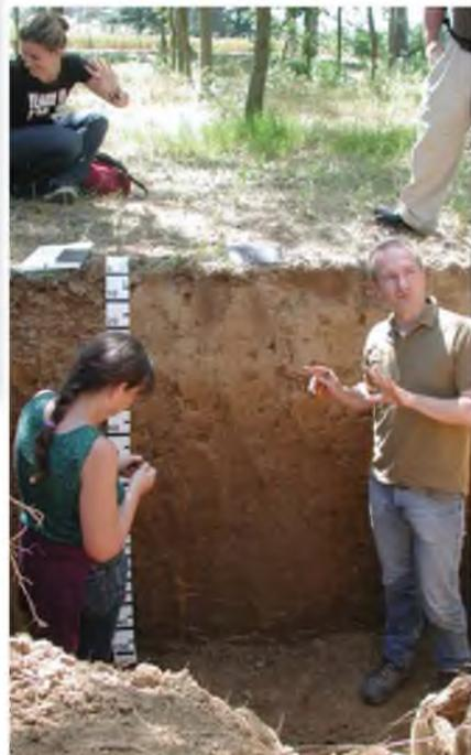
Las calicatas o perfiles son una de las técnicas de prospección empleadas para facilitar el estudio de los suelos. Son excavaciones de profundidad pequeña a media, realizadas normalmente con pala retroexcavadora. El término proviene del latín, *chalāre* ("penetrar", "atravesar"), y del griego, *kata* ("hacia abajo") (CG)
