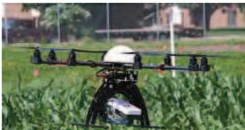
**Figura 8.** Sensor ativo de dossel embarcado em VANT. <http://hollandscientific.com/>
