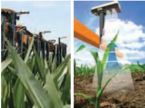
**Figura 7.** Sensores ativos de dossel acoplados em máquinas agrícolas para aplicação em taxas variáveis de nitrogênio em milho.
