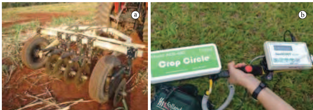
Figura 1. Sensores de coleta de dados em Agricultura de precisão: a) sensor de condutividade elétrica (Veris); b) sensor de índice de vegetação (Crop Circle). Foto a: Célia Grego. Foto b: Cristina Aparecida G. Rodrigues.
